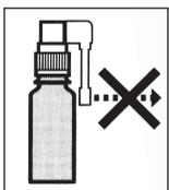
1. Bitte biegen Sie das Sprührohr des Sprühkopfes nicht nach vorne hoch.
